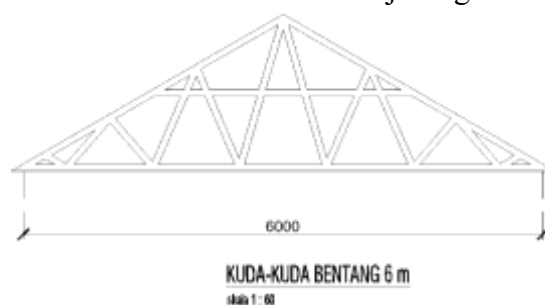
Gambar 6. Permodelan Konstruksi Rangka Atap Baja ringan untuk Bentang 6 m
