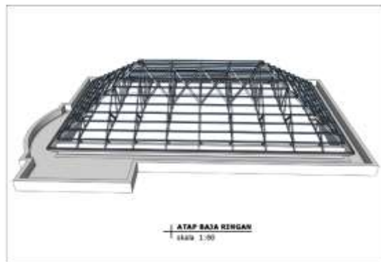
4: Rangka baja ringan untuk gedung (Sumber: Rachmaiyanti / gambar pribadi)
