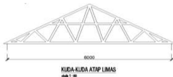
8. Permodelan Konstruksi Rangka Atap Baja ringan untuk atap limas
