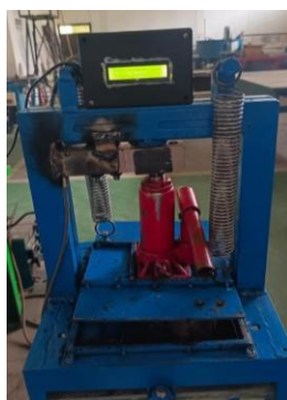
Gambar 1. Alat pengempa biobriket yang telah dimodifikasi dengan sistem sensor tekanan dan LCD
